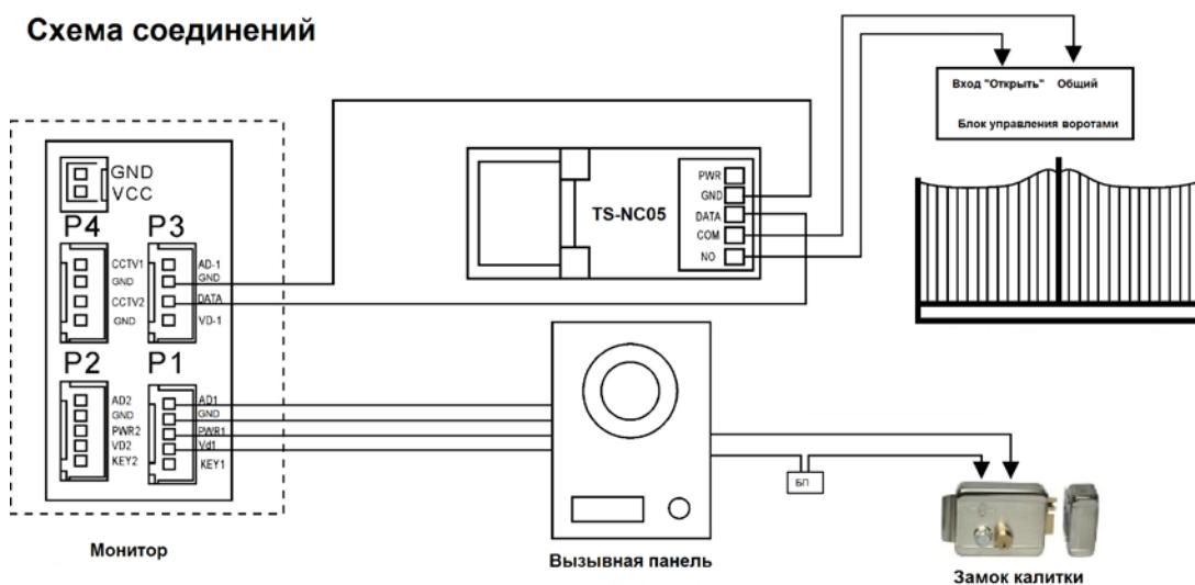
**Внимание:** При подключении электронного реле к блоку управления воротами требуется соблюдать полярность. Запрещается подключать устройства имеющие потребляемый ток выше 5mA и напряжение выше 30В пост. тока.
